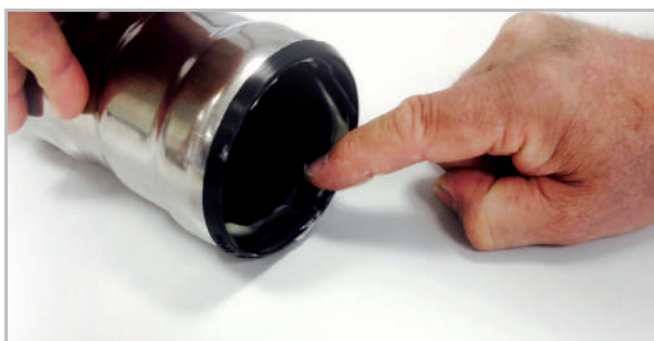
Bild 6 – Schmierung des internen Bereichs der Dichtung
