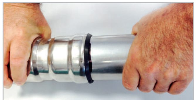
Figura 7 - Inserimento tubo nel raccordo
